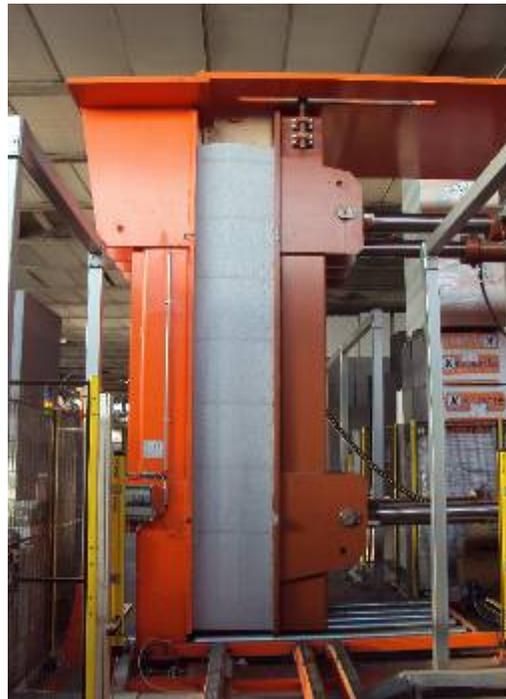
I blocchi vengono pressati con un processo produttivo controllato e bilanciato elettronicamente fino ad ottenere l'allentamento delle tensioni interne allo stesso in ogni suo punto.
